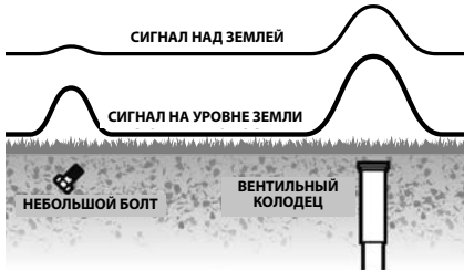
Рис. 6 – Подъем трассоискателя уменьшает сигналы-помехи
